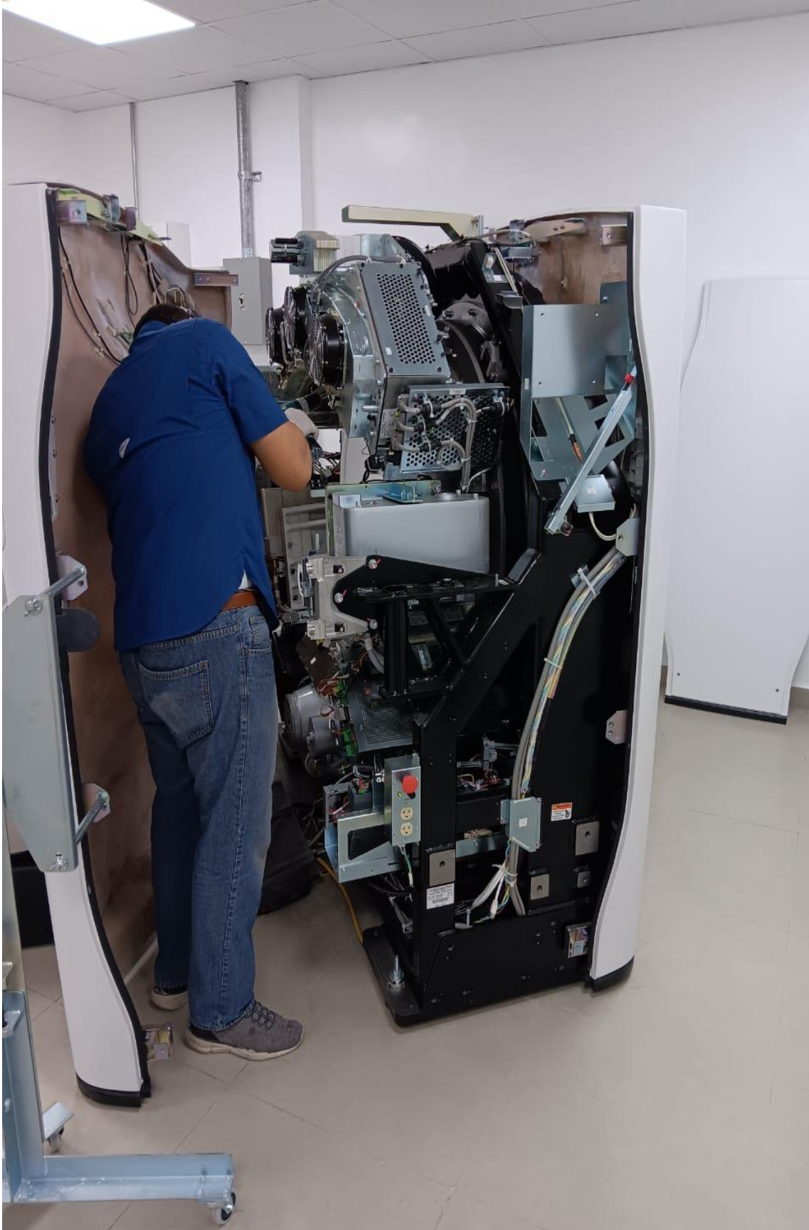
Mantenimiento al sonógrafo 13/02/2024
