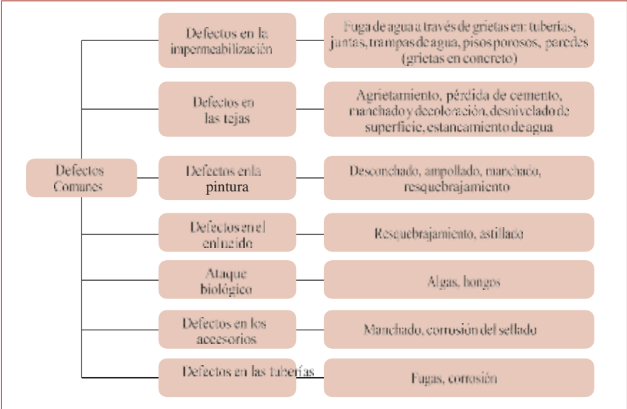
Defectos comunes en elementos de la infraestructura de los establecimientos de salud
