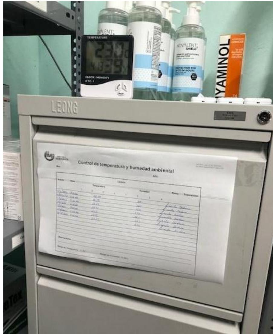
Ilustración 17 Control de temperatura y humedad del almacén, es tomada diario.
