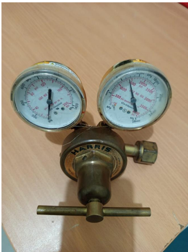
Colocación de manómetros de presión para regulación de oxígeno
