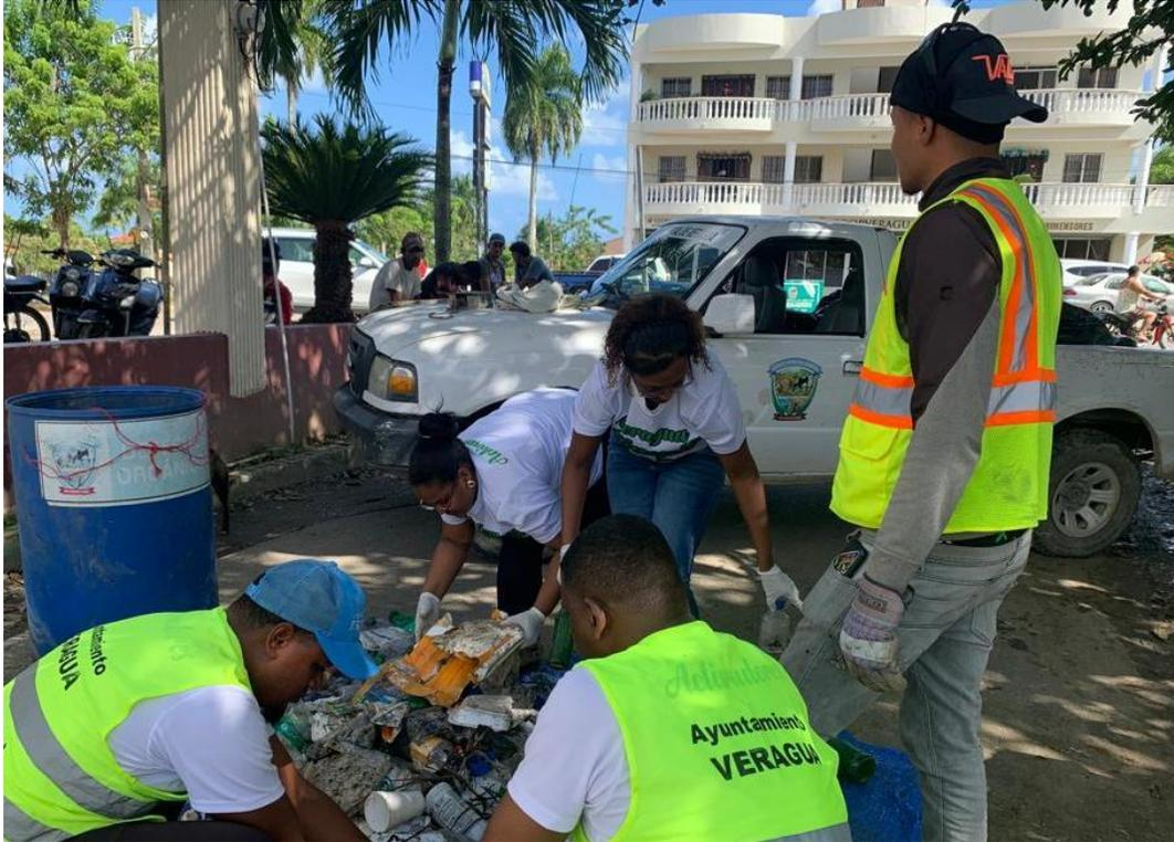
Se tomó la muestra homogénea, se dividió en cuatro partes iguales para posteriormente tomar dos extremos y volver a mezclarlos hasta obtener una muestra aproximada de 100kg (método del cuarteo).
