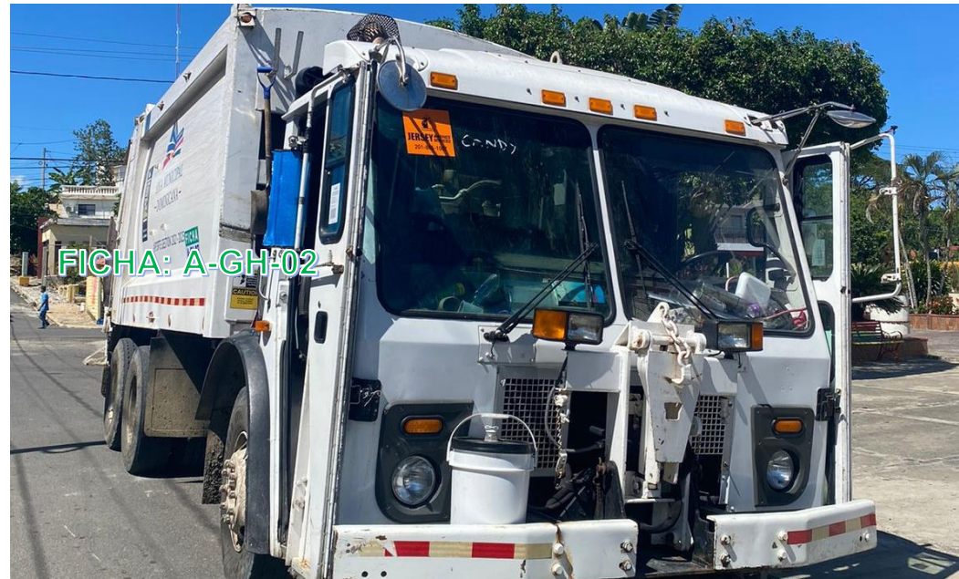
A-GH-02, Camión Compactador MACK-LEU cerrado, para la recogida de los Residuos Sólidos.
