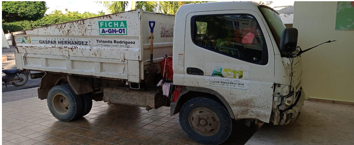
A-GH-01, Camión de volteo pequeño para la recogida de los Residuos Sólidos, Abierto con Lona.
