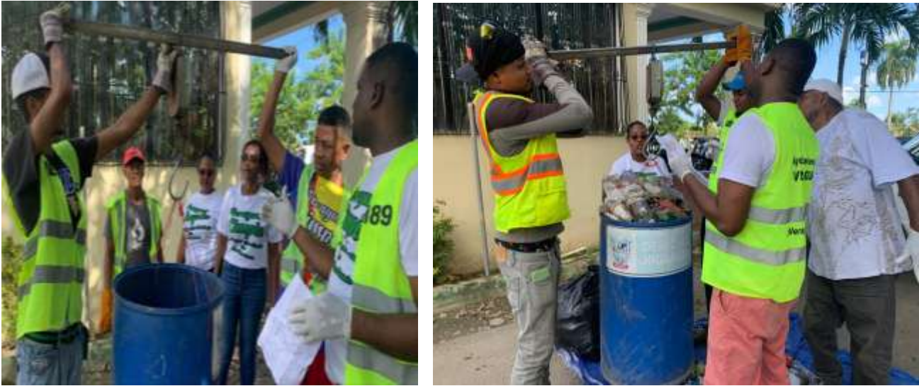
Ilustración 3.4-8 Método utilizado para la determinación de la densidad de los RSD.
