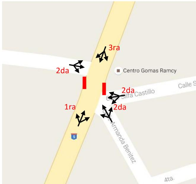
En esta intersección existen tres fases controladas por semáforo; en una de las fases, dos calles (C/ Silfa Castillo y C/ Amanda Benítez) responden a una sola cara de luces y por otro lado en una fase se libera el paso a tres calles simultaneas.
