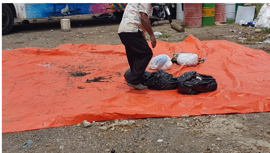
Ilustración 3.4-10 Obrero abriendo las bolsas con residuos para el inicio de la homogeneización de estos
