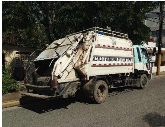
Figura No. 10 Camión compactador de carga trasera, fuente de foto: elaboración propia
