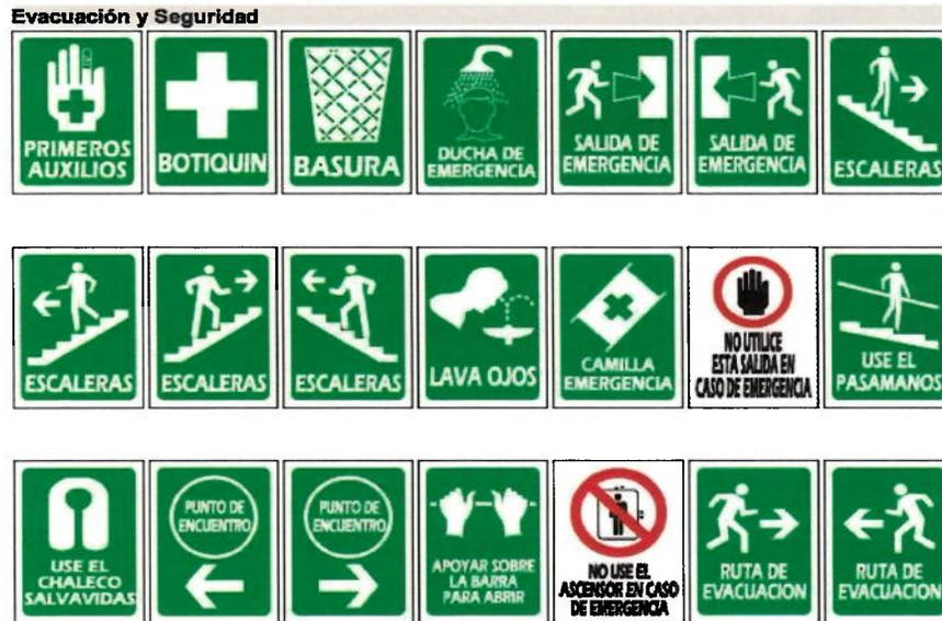
Fig.7: Tipos de Señalización de Seguridad. Señales informativas de Evacuación y Seguridad.
