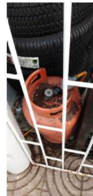
Tanque de gas oxidado
