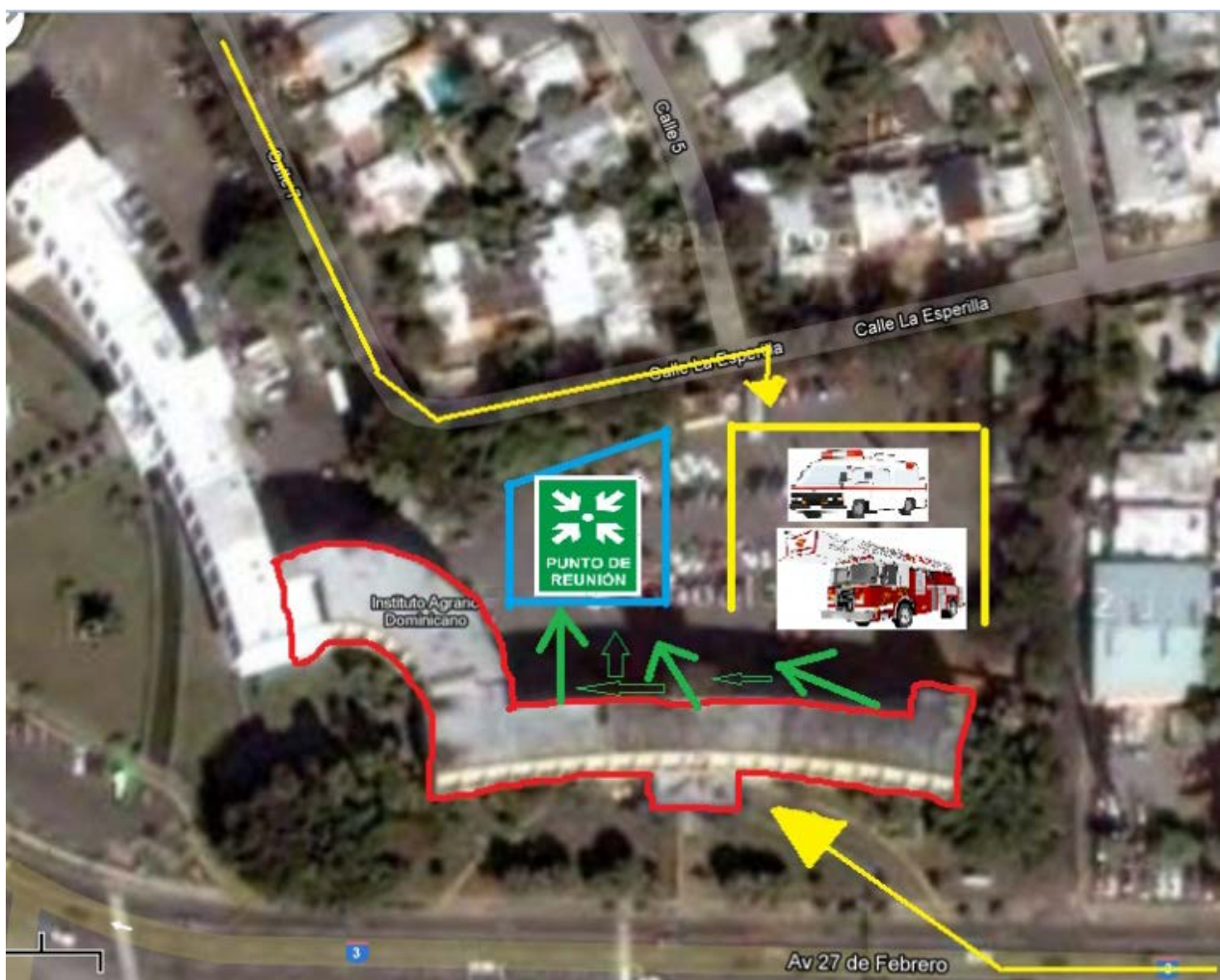
Ilustración 1: Vista area de la edificación donde se marcan los puntos de reunion y los medios de entrada de los organismos de Socorro.
