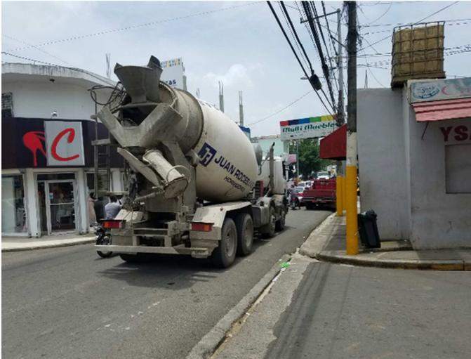
Paso de vehículos pesados y maquinaria de trabajos de construcción por el casco urbano del Municipio de Cotuí. Esta situación entorpece el tránsito normal del Municipio, genera suciedad, contaminación y específicamente del caso de la Imagen I-1. Los Camiones Trompo tienden a derramar hormigón en el asfalto, endureciéndose este y dañando la vía pública.
